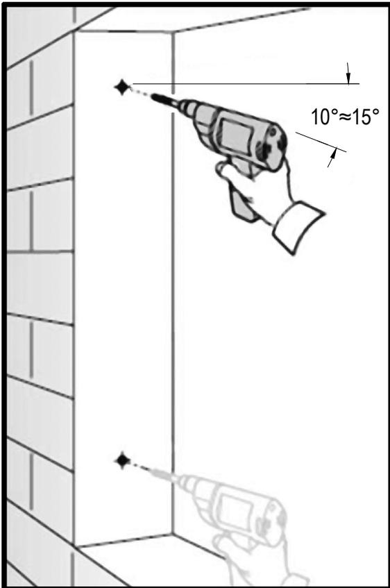
Verificare il tipo di muro dove va fissata la grata per scegliere correttamente i tasselli di fissaggio. I fori per i fissaggi sono  $\text{Ø}8.5\text{mm}$
